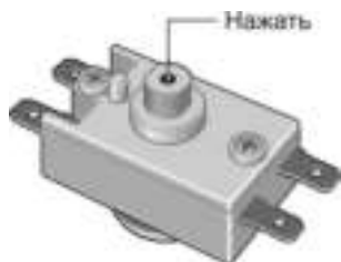
Рисунок 3. Расположение штока на термовыключателе.
