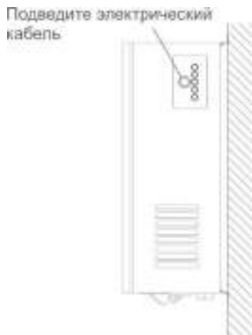
Рис.8. Расположение панели вывода электрического кабеля
