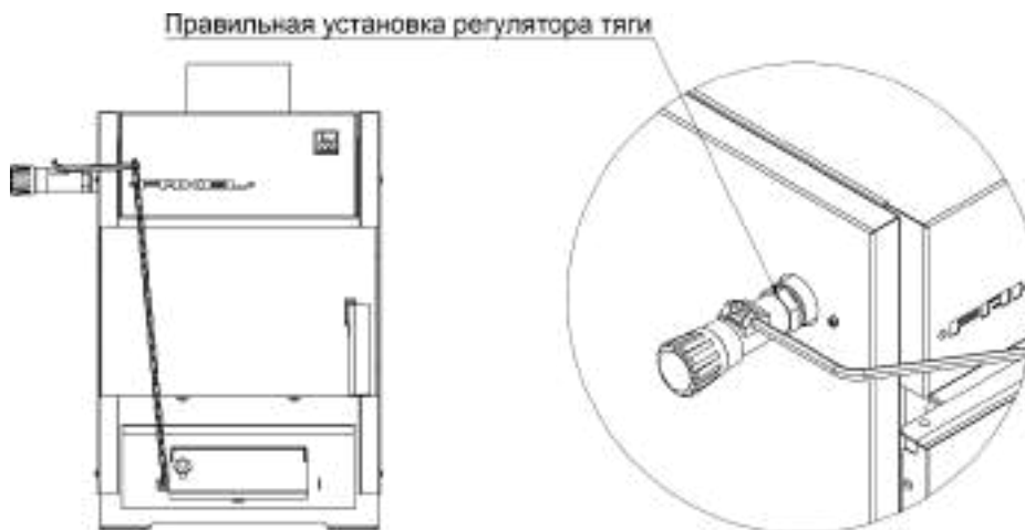
Рис. 8 Установка регулятора тяги
